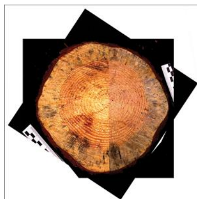
Рисунок 2. Применение функции Компаратор при совмещении годовых колец на спилах сравниваемых объектов.
